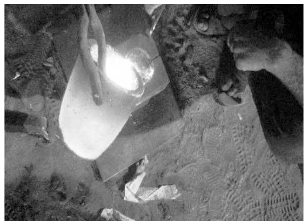
Fig. 2.2. Pouring of liquid metal in die pattern.
