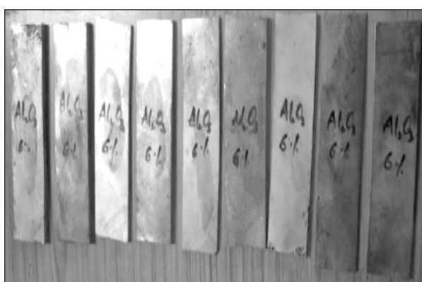
Fig. 9. Al 7178 - 6% Al 2 O 3 rolled samples.
