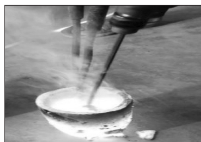
Fig. 2. Stir casting technique.
