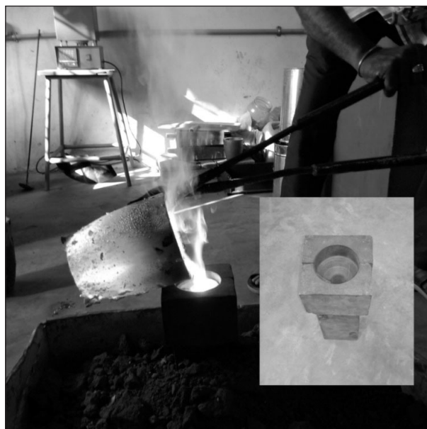
Fig 2. Molten Metal pouring into Die
